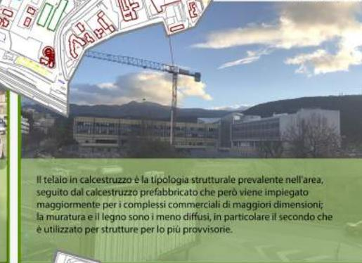
Il telaio in calcestruzzo è la tipologia strutturale prevalente nell'area, seguito dal calcestruzzo prefabbricato che però viene impiegato maggiormente per i complessi commerciali di maggiori dimensioni; la muratura e il legno sono i meno diffusi, in particolare il secondo che è utilizzato per strutture per lo più provvisorie.
